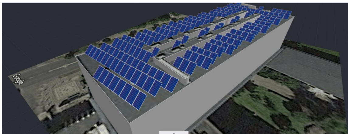
Rys. 5. Umieszczenie modułów fotowoltaicznych na dachu budynku głównego ZST w Rybniku.
